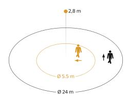
Hauteur d'instal lation: 2,00 m – 4,00 m Orange: sens de passage radial Noir: sens de passage tangentiel
